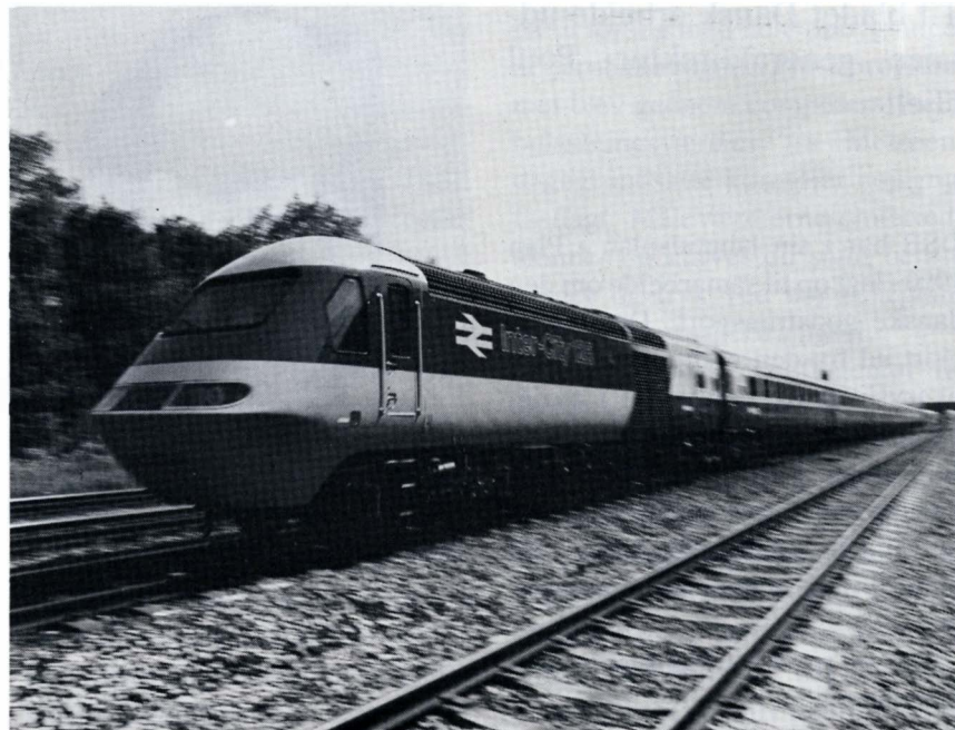
LOKOMOTIVET: HST har sat verdensrekord for dieseltrækraft på eksisterende spor - 230 km/t, som bliver fremtidens fartområde. To lokomotiver udvikler tilsammen 4500 hk.
